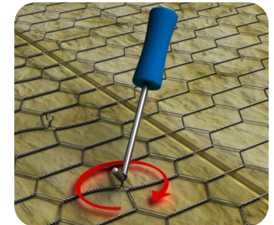
Methode 2: verweven van het gaas met de 'haakmethode'
